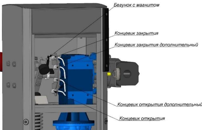
Концевик открытия отвечает за остановку шлагбаума в крайней вертикальной точке, при срабатывании на самом концевике и на плате загорается индикация: зеленый – ОТКРЫТО
