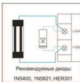
Рис.6 Установка защитного диода
