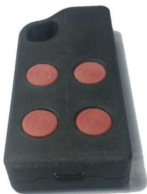
Брелоки запитываются батарейками аккумуляторного типа. Зарядка батареек осуществляется через разъем типа Туре-С (Рисунок 3). При зарядке индикатор горит красным цветом.
