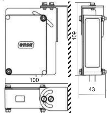
**Установка на площадке с уголком:** уголок крепится к несущей поверхности, площадка - к уголку, извещатель - к площадке и имеет возможность поворота на  $\pm 5^\circ$  по вертикали и на  $\pm 90^\circ$  по горизонтали.
