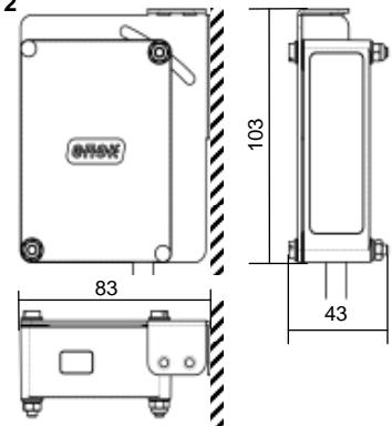
**Установка на площадке без уголка:** площадка крепится перпендикулярно к несущей поверхности, извещатель крепится к площадке и имеет возможность поворота на  $\pm 5^\circ$  по вертикали.
