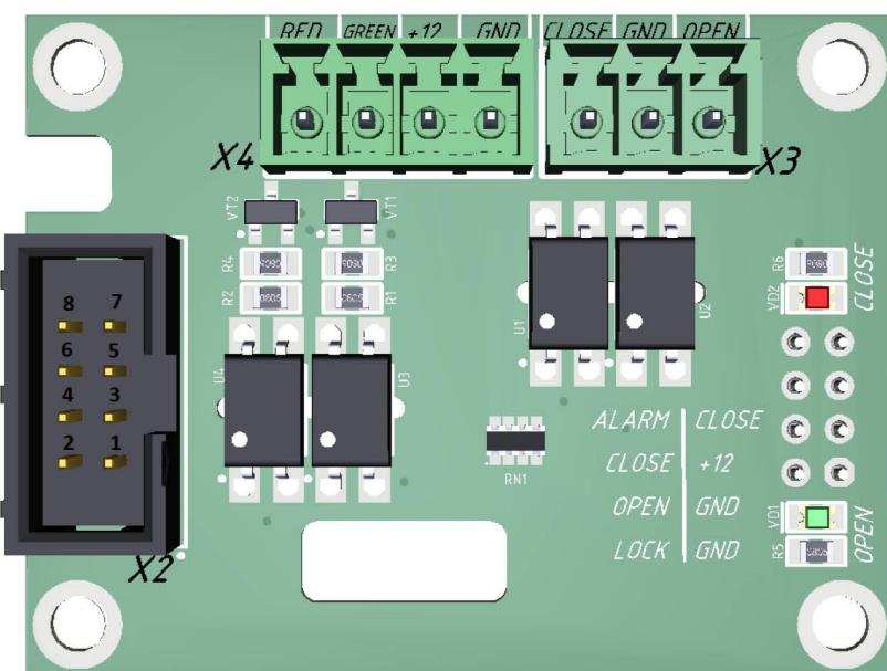
Для получения сигналов о положении шлагбаума (открыт / закрыт) стороннее оборудование подключается к разъему X3, сигнал считается положительным при закорачивании на землю.
