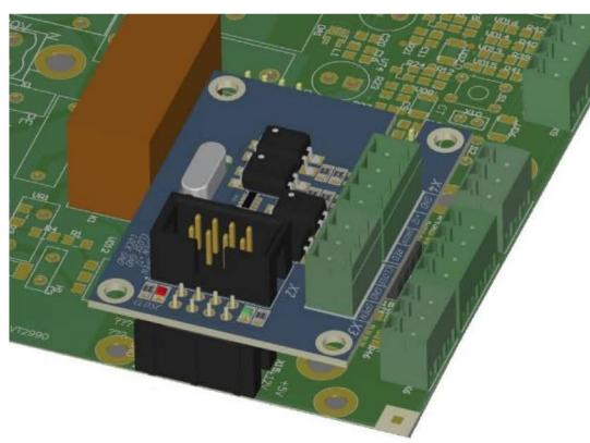
В плату шлагбаума «Цифра-1М» модуль подключаются к разъему X15 и закрепляется на ней через дистанционные втулки винтами М3 (входят в комплект) через крепежные отверстия
