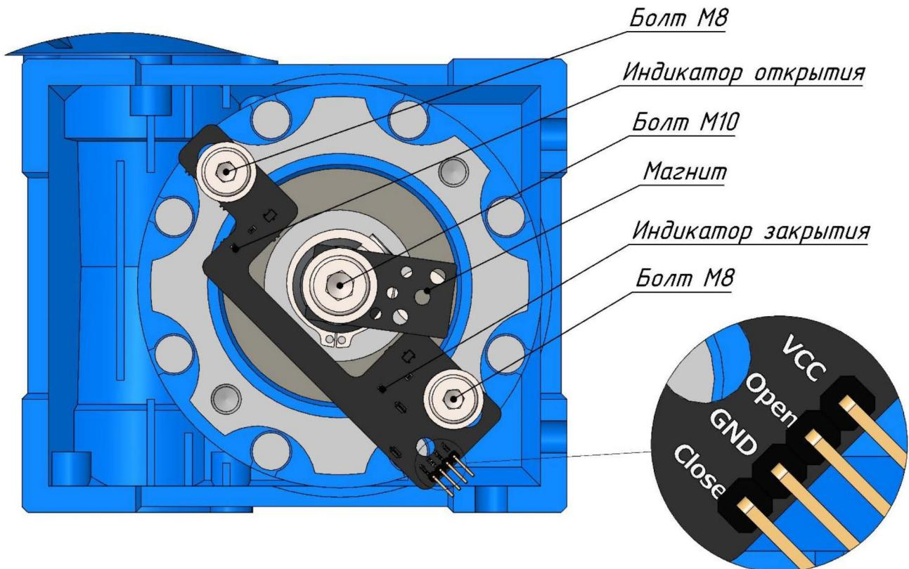
Работа концевых выключателей регулируется поворотом основания с магнитом смотри рисунок.
